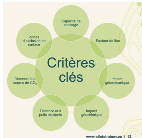
Figure 1. Critères clés analysés pour optimiser l'emplacement théorique d'un puits d'injection de CO 2 .
