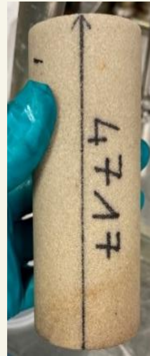
Mesure directe de porosité et perméabilité au laboratoires d'IFPEN
